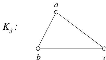
$$A = \begin{matrix} & \begin{matrix} a & b & c \end{matrix} \\ \begin{matrix} a \\ b \\ c \end{matrix} & \begin{bmatrix} 0 & 1 & 1 \\ 1 & 0 & 1 \\ 1 & 1 & 0 \end{bmatrix} \end{matrix} \quad A^2 = \begin{bmatrix} 2 & 1 & 1 \\ 1 & 2 & 1 \\ 1 & 1 & 2 \end{bmatrix} \quad A^3 = \begin{bmatrix} 2 & 3 & 3 \\ 3 & 2 & 3 \\ 3 & 3 & 2 \end{bmatrix}.$$
